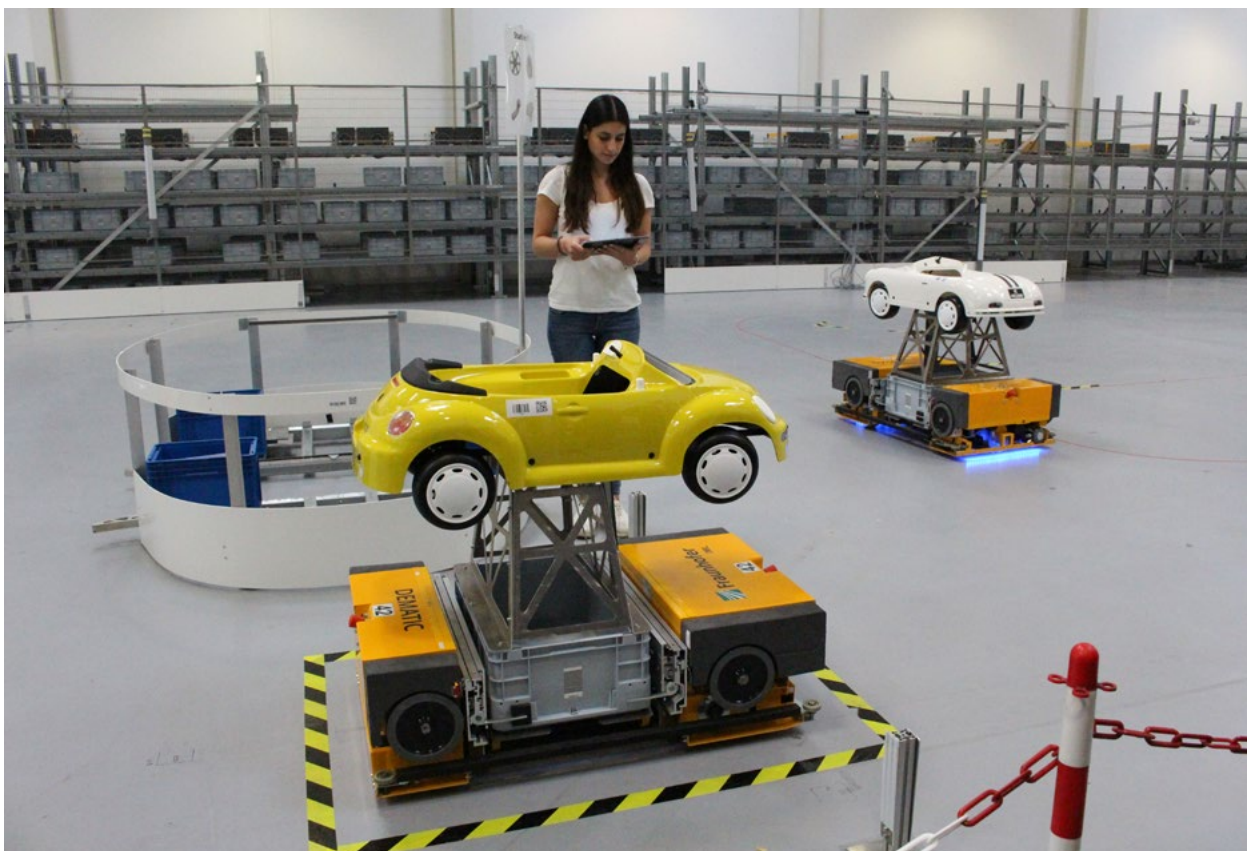
In einer Versuchseinrichtung werden zellulare Transportfahrzeuge erprobt.
