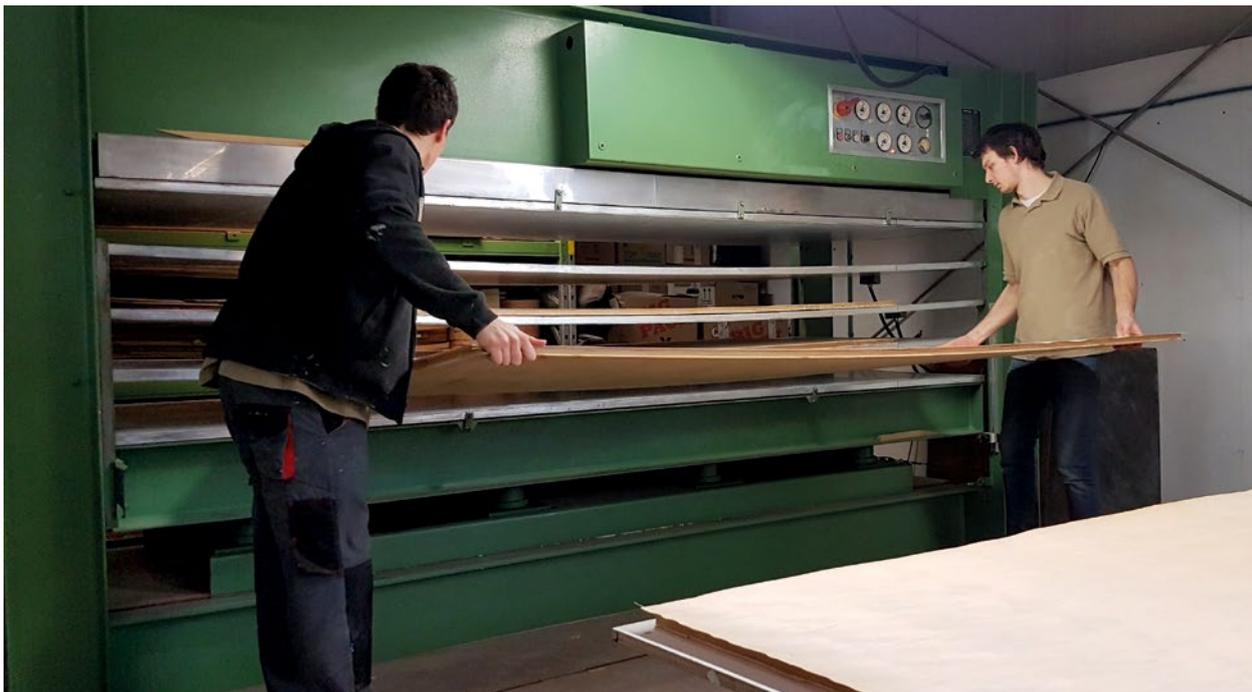
Die mehrlagige Sperrholzplatte wird aufwendig verpresst.
