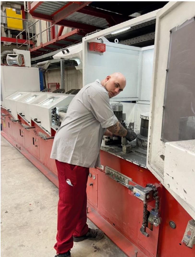
Die Ziehmaschine wird manuell eingestellt.
