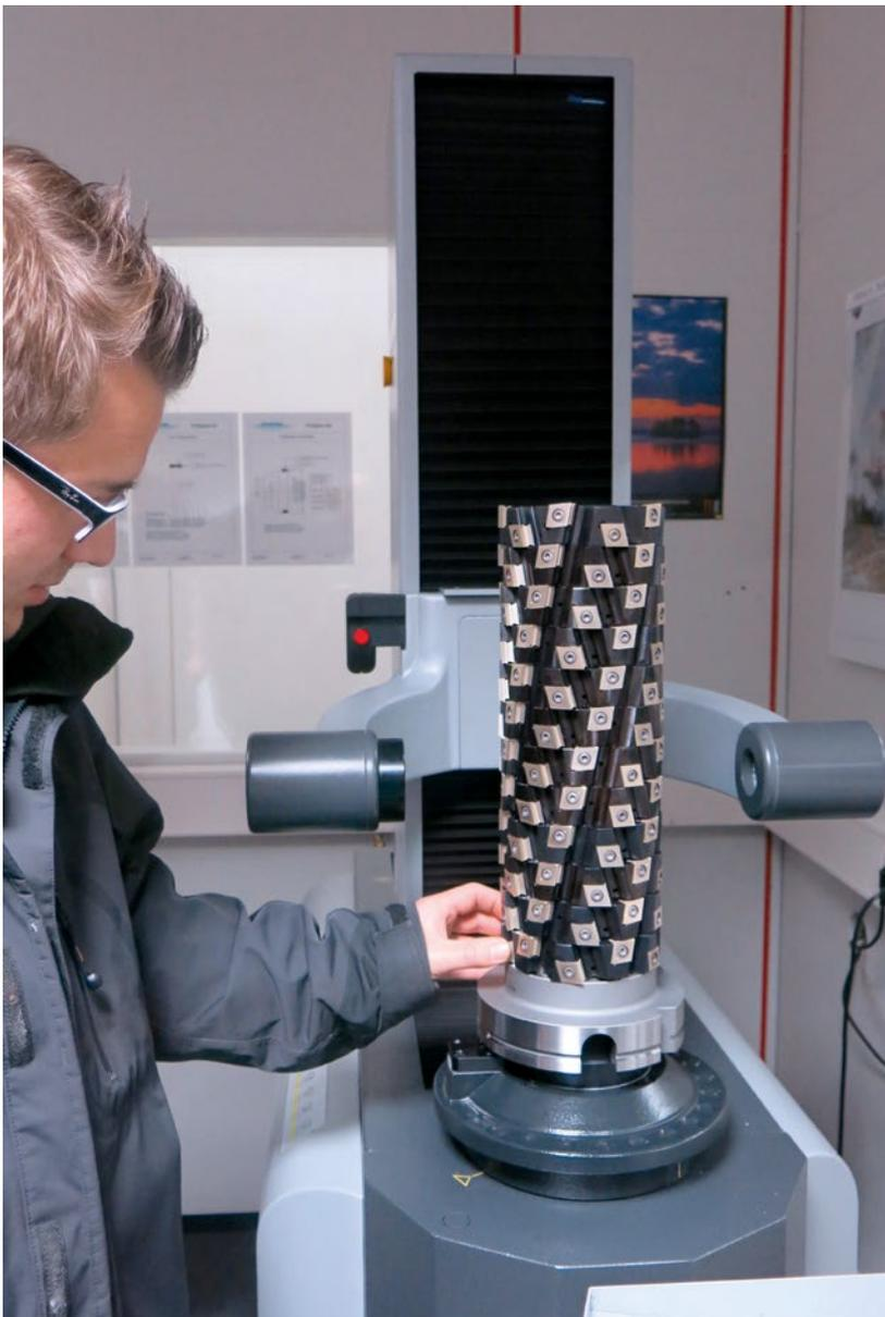
Der hochpositive Walzenfräser ist bereit für den Zerspanungsprozess.
