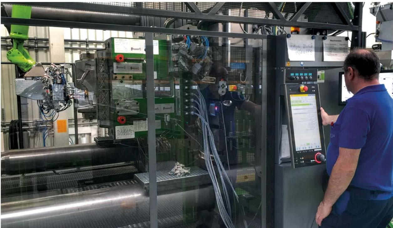
Die Produktion von Stoßfängerüberzügen erfolgt hier auf einer 4.000-Tonnen-Spritzgießmaschine.
