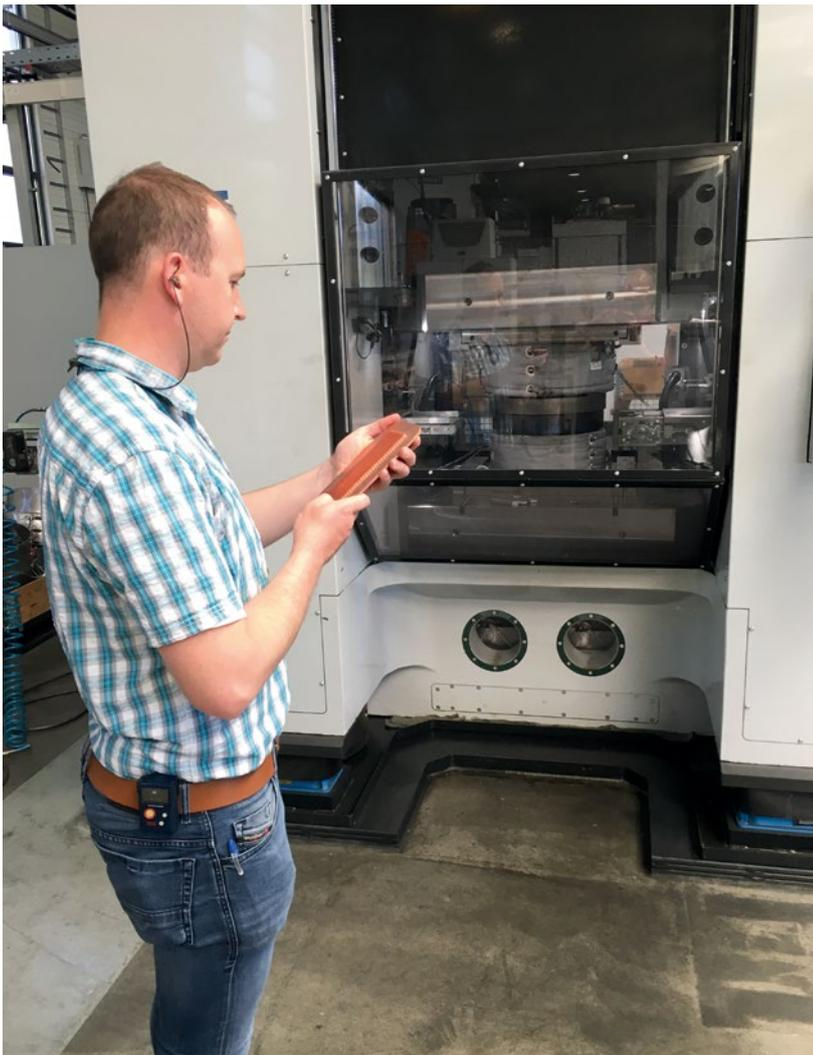
Die Massivumformung der begutachteten Kühlplatte erfolgt in einem mehrfach wirkenden Presssystem.
