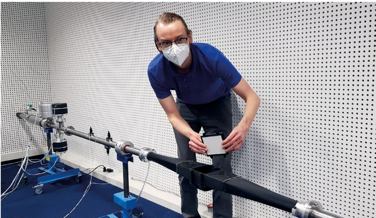
Der Metamaterial-Resaktor wird am Akustik-Prüfstand aufgebaut.
