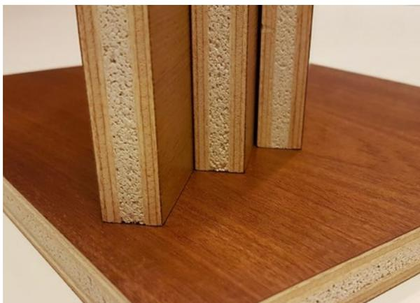
Es wird eine regenerative Sperrholzplatte entwickelt, die den Brandanforderungen im Schiffsinnenbau gerecht wird.
