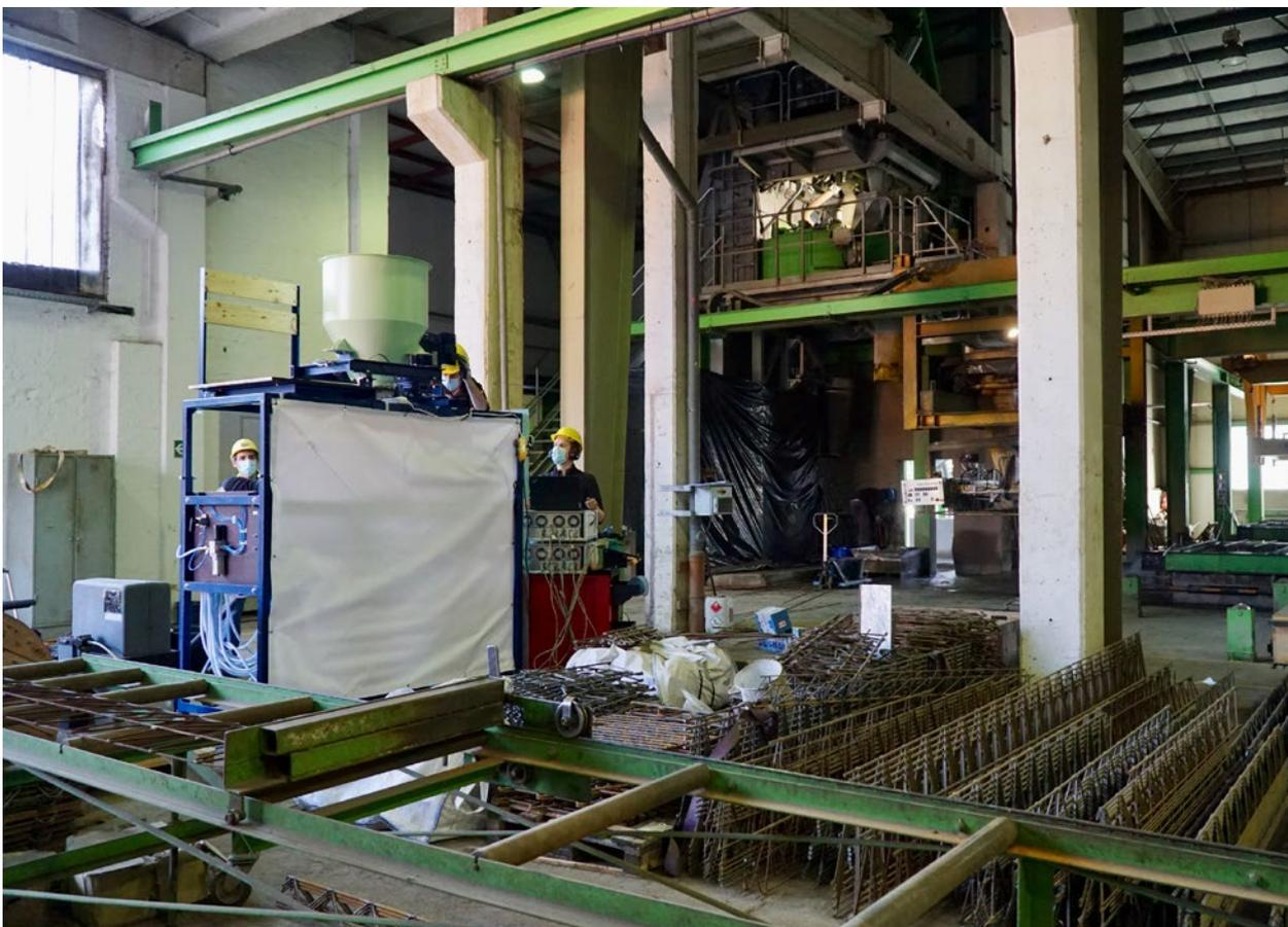
Die Ultraschallbetonmischanlage ist als Werksversuch im Einsatz.
