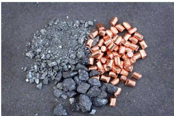
Dies sind Legierungselemente zur Herstellung blei- und nickelfreier Werkstoffvarianten.
