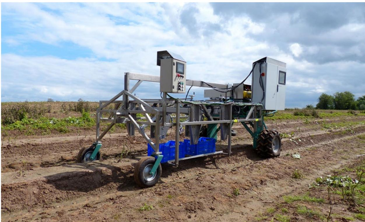
Ein provisorisches Fahrgestell hilft bei der automatischen Grünpargelernte.
