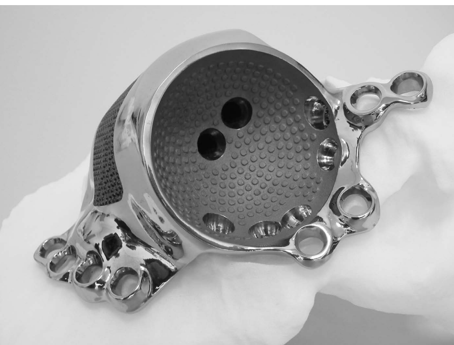
3D-gedrucktes patientenspezifisches Hüftimplantat aMace aus Titan
