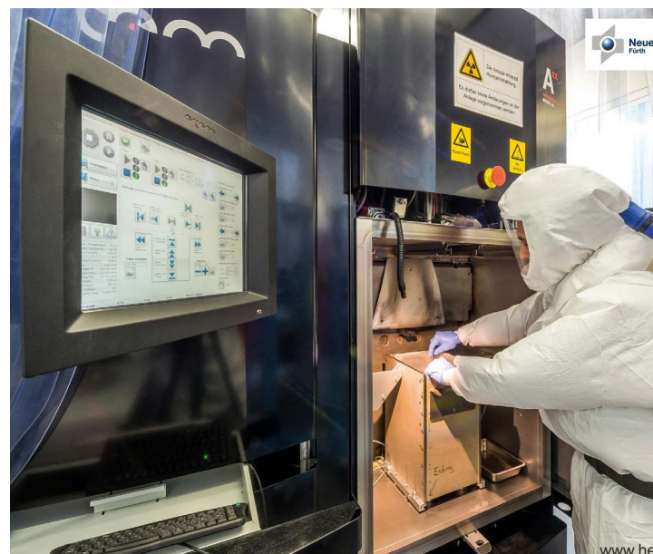
Entnahme von Bauteilen, die durch additive Fertigung hergestellt wurden
