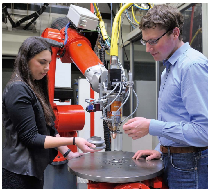
Industrieroboterbasierte Anlage für das Laserauftragschweißen
