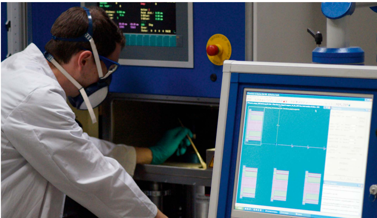
Im Rahmen des Vorhabens verwendete SLM-Maschine für die Ermittlung optimaler Prozessparameter für die Verdichtung von Werkzeugstahlpulver, hier: Entnahme der hergestellten Proben für die nachfolgende Gefügeuntersuchung
