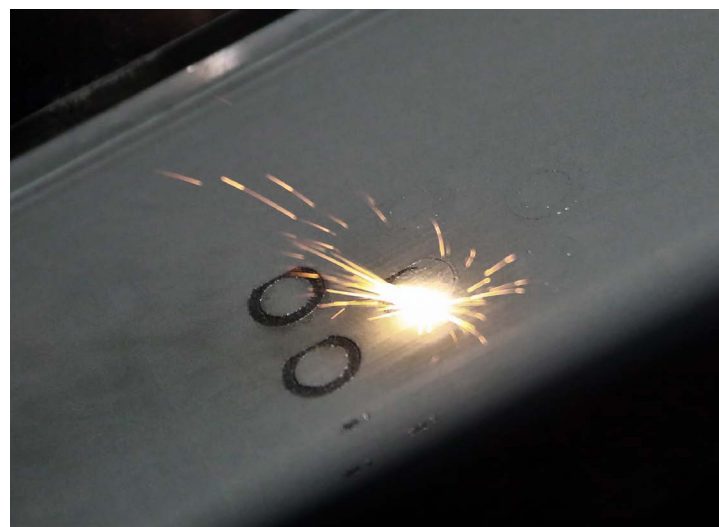
Der Laser schmilzt die oberste Schicht.
