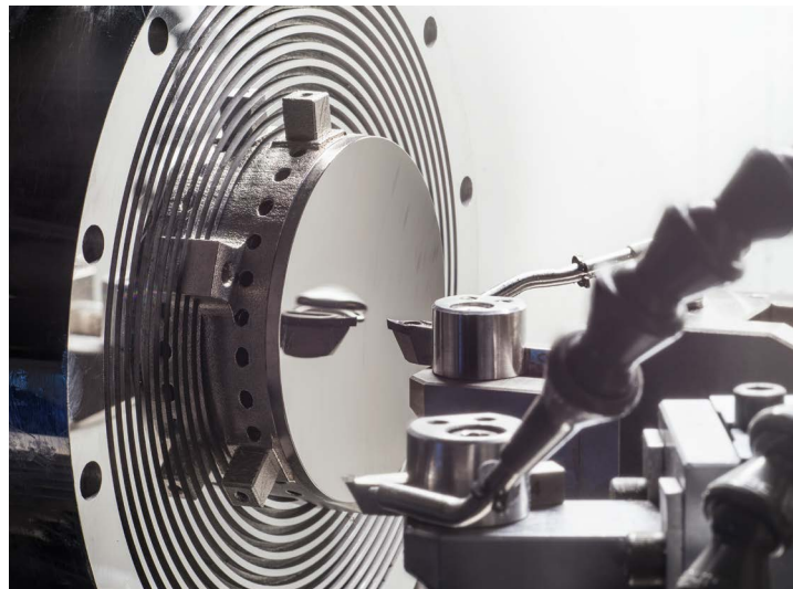
Leichtgewichtsspiegel auf Ultrapräzisionsbearbeitungsmaschine
