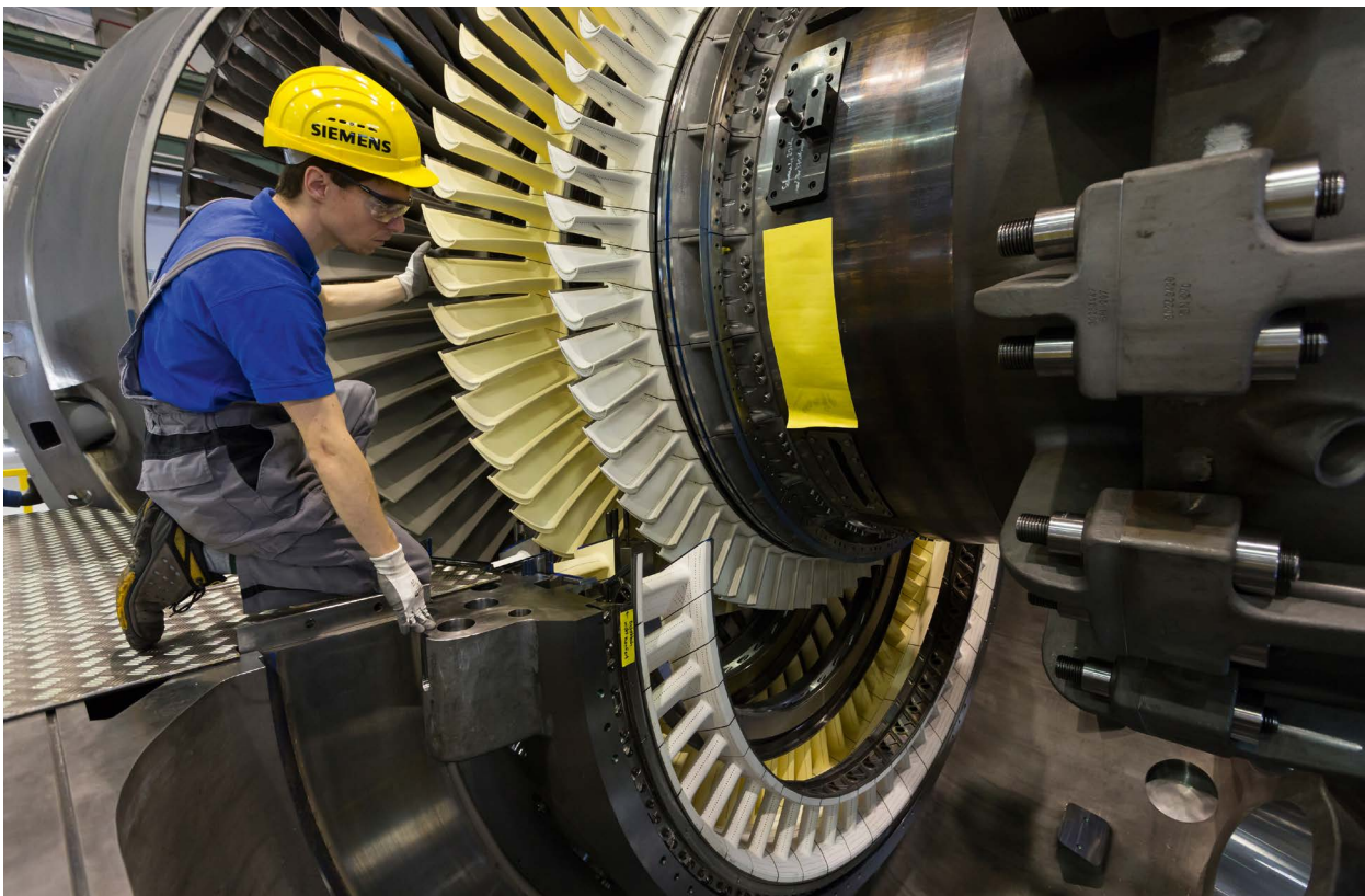
Montage einer Turbine
