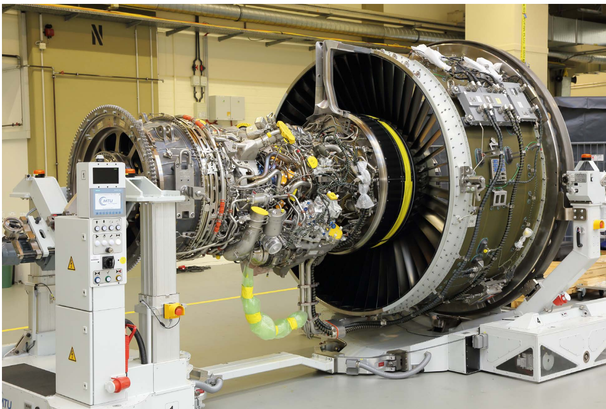
Getriebefan-Triebwerk PW 1100G-JM für Airbus A320neo mit TiAl-Beschaffung der letzten Niederdruckturbinenstufe auf der Montagelinie
