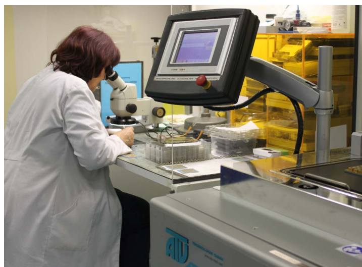
Qualitätskontrolle des Siebdruckprozesses auf Keramikschaltungsträger
