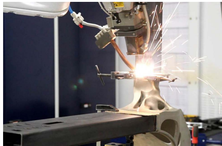
Die Laserschweißtechnik in Kombination mit dem prozessgerechten Bauteildesign ermöglicht ein hochpräzises Fügen von filigranen Leichtbaustrukturen bei minimalem Wärmeverzug.
