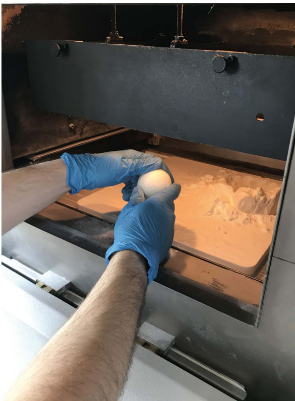
Probenentnahme aus einer Laser-Sinter-Anlage
